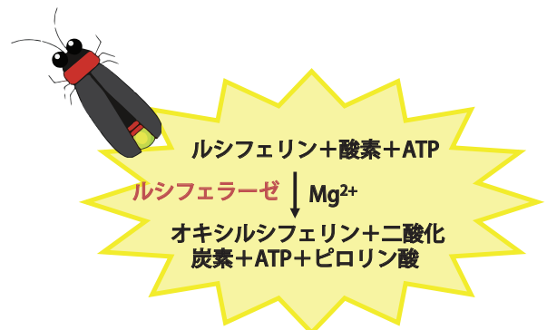
図2 ATPの超高感度測定の原理
